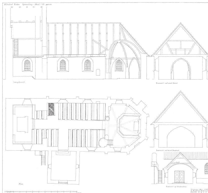
Fig. 19a-e. Opmåling af kirken 1939. 1:300. a. Plan. b. Længdesnit set mod nord. c. Tværnsnit set mod øst. d. Tværnsnit set mod vest. e. Tværnsnit gennem våbenhus. Målt og tegnet af Ejnar Mindedal Rasmussen 1939. I NM. — Scale drawing of the church, 1939. a. Plan. b. Longitudinal section looking north. c. Cross-section looking east. d. Cross-section looking west. e. Cross-section through the porch.
