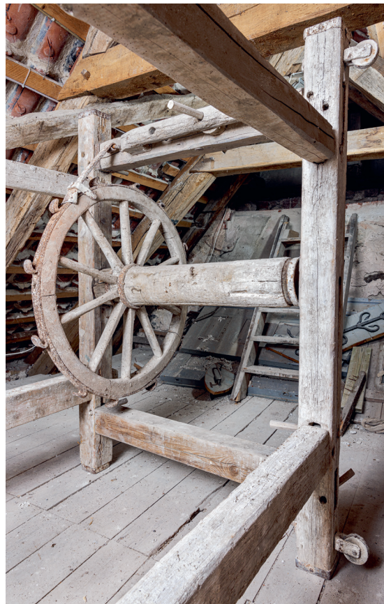
Fig. 56. Kalkevogn. Detalje med hjul og spærhage (s. 6345). Foto Arnold Mikkelsen 2023. – Limewashing carriage. Detail with wheel and ratchet.
