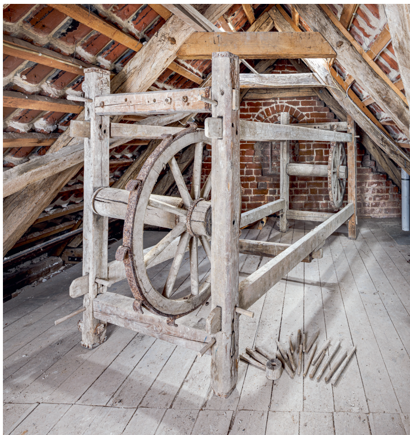
Fig. 55. Kalkevogn på våbenhusets loft (s. 6345). Foto Arnold Mikkelsen 2023. – Limewashing carriage in the loft of the porch.
