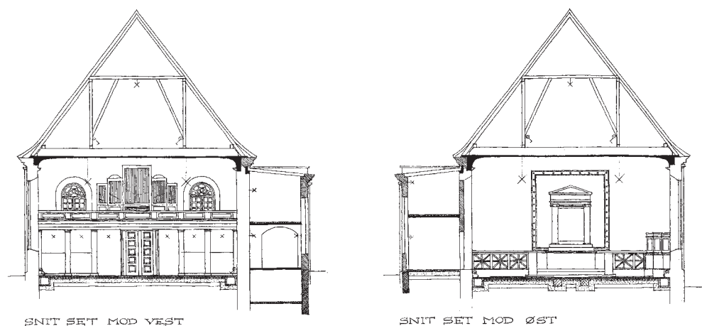
Fig. 10. Den nuværende kirke. Tværnit mod vest og øst, 1:300. Forslag til kirkens genopbygning ved B. Billund 1955. – Present-day church. Cross-section towards west and east, 1:300.
